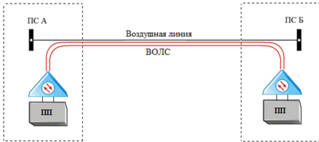
Рис. 3. Организация работы приемопередатчиков (ПП) по двум выделенным ВОЛС по схеме «точка-точка».
