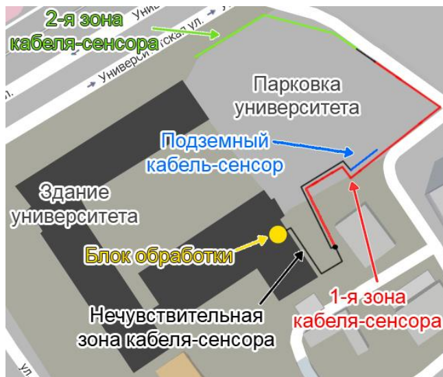
Рис.1. Схема расположения кабель-сенсора при проведении исследований.
